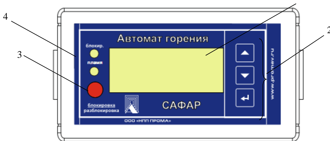
Рисунок 3. Лицевая панель блока управления САФАР. 1 – OLED; 2 – кнопки управления; 3 – кнопка возврата; 4 – светодиоды.
