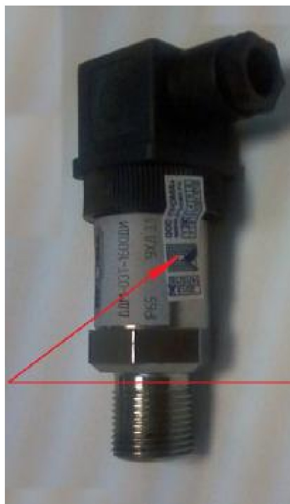
Рисунок 2 - Место пломбирования датчиков
